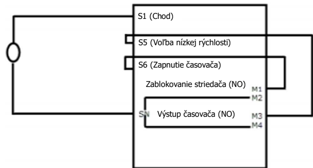
Obrázok 2 – Ukážková schéma pre aplikáciu funkcie pozastavenia rozbehu prostredníctvom digitálnych vstupov/výstupov
